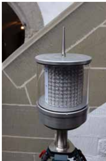
Le nouveau feu à éclipse pour les avis de coup de vent
